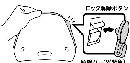
帽体縁に付属の解除パーツ(紫色)を使い、左右のロック解除ボタンを中に押し込みます。
